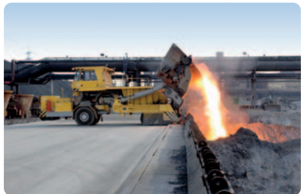
Pott-Carrier transportieren die glühende Schlacke zu den Schlackenbeeten
