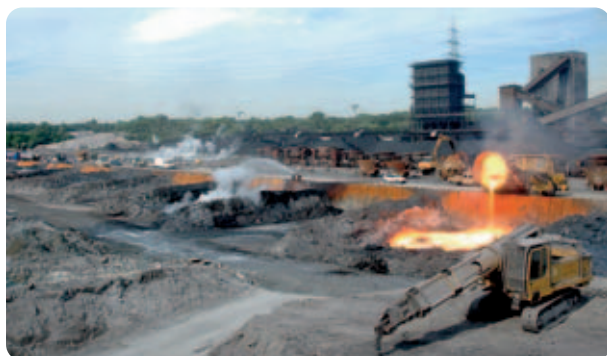
Abkippen der Stahlschlacke in die Schlackenbeete
